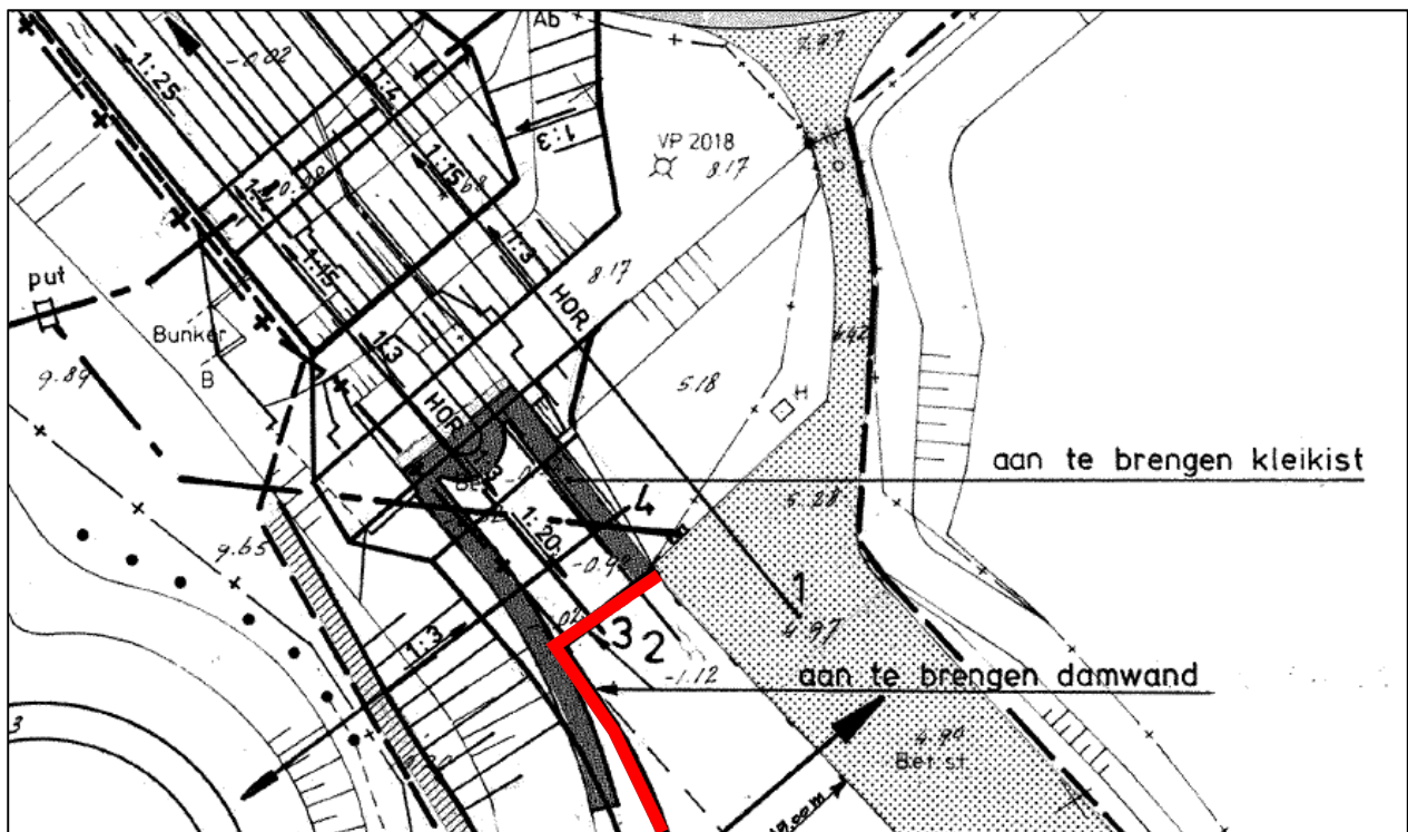
Figuur 4—1: Bovenaanzicht verholen inundatiesluis
